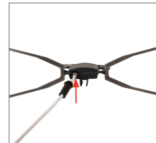
Skru konnektoren på F-stikket. Fest konnektoren, monter gummihylsen i huset
